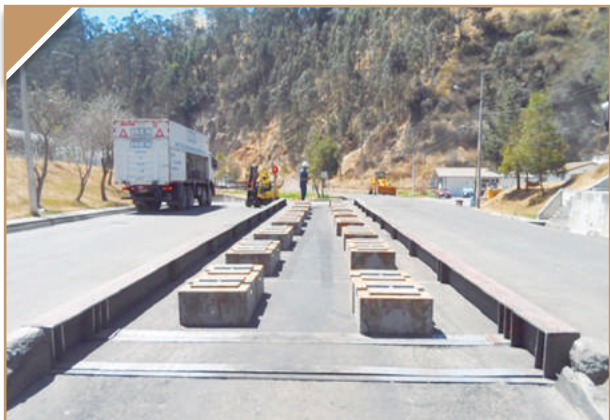
Colocación de pesos estándar por parte del INEN para comprobar el funcionamiento de la báscula
