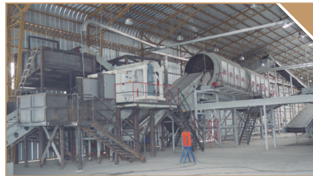
Trommel para separar los residuos orgánicos con un movimiento giratorio
