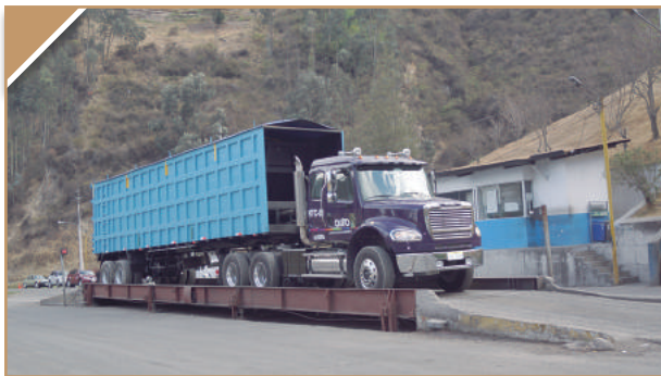
Pesaje de un tractocamión en la báscula de la Estación de Transferencia Norte
