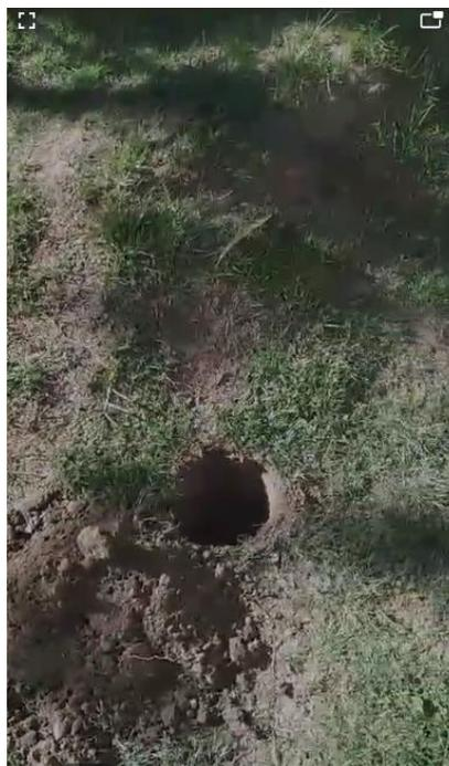
**Fotografías 4 y 5.** Toma de submuestras de suelo para formar una muestra compuesta
